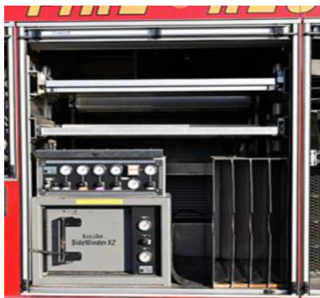
Cascade Fill System
